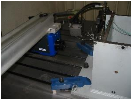
Analyse de défauts de roulements par thermographie IR (LTP-LMA)
