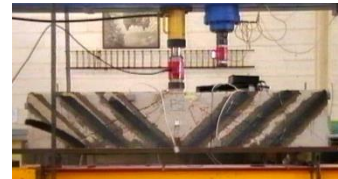
Tests de structure renforcée et de structure mixte acier-béton collée (LGC)
