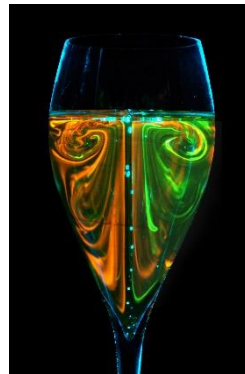
Visualisation d'écoulements par plan laser (LTM)
